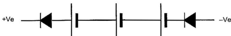
Hình E.2 – Bố trí điốt chặn để đáp ứng E.4.3 (ví dụ thứ ba)
